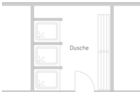
Beispiel für den Einbau einer Nassraumtür. Die Tür führt in einen Raum, in dem mit hoher Luftfeuchtigkeit und ständigem Spritzwasser zu rechnen ist.
